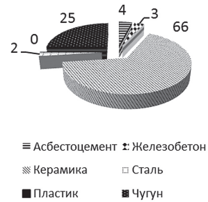
Рис. 7. Материал, из которого выполнены трубы распределительных сетей
